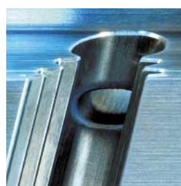
Bearbeitung von Turbinenscheiben für Rolls Royce Deutschland Machining of turbine discs for Rolls Royce Deutschland
